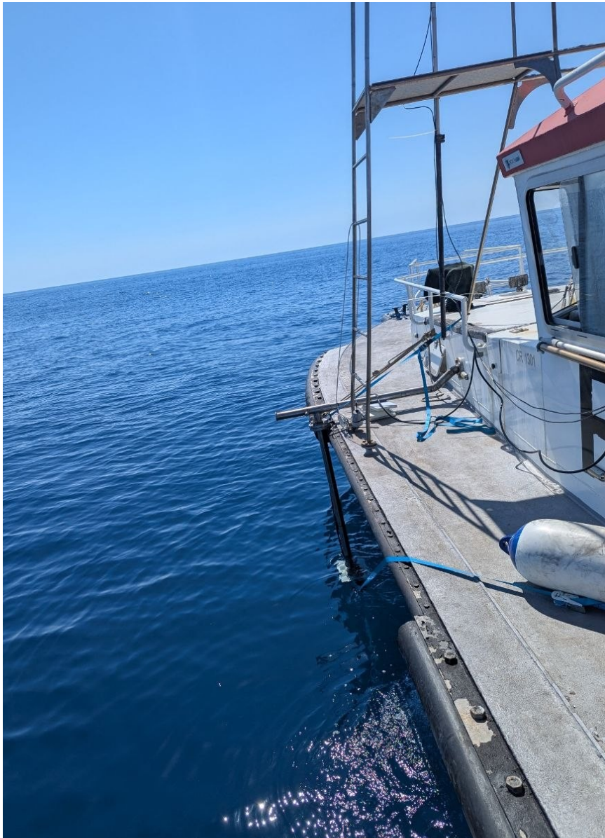
Figura 4: M/N Orso Bianco: particolare dell'istallazione a palo del MBES
